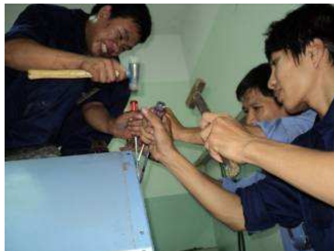
Foto 8. Storebro Schweden hat vor einigen Jahren diese Maschine umgespritzt auf Storebro blau. Und dann alle Bleche mit Silikon angemacht. Das ist echt schlimm, fast nicht lösbar, das Silikon klebt extrem.
