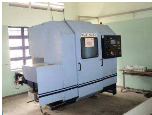
Foto 4. Hier steht eine CNC Vertikal Drehmaschine die Maschinen Nr.10024 im Raum der Gewerkschaft Schule von Frau Lan.
