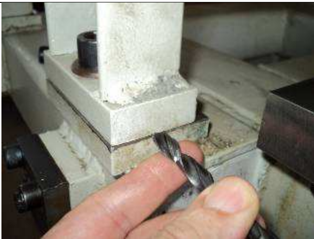
Foto 22: Eine Alternative wie man auch konische Stifte setzen kann seitwärts.
