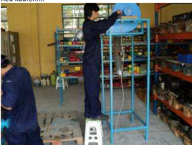
Foto 30: Für die Malerei machen wir in der Montage einen zusätzlichen Absauglüfter. Diesen brachten wir mit aus der Schweiz aus einer Schreinerei. Hier leistet er uns gute Dienste.
