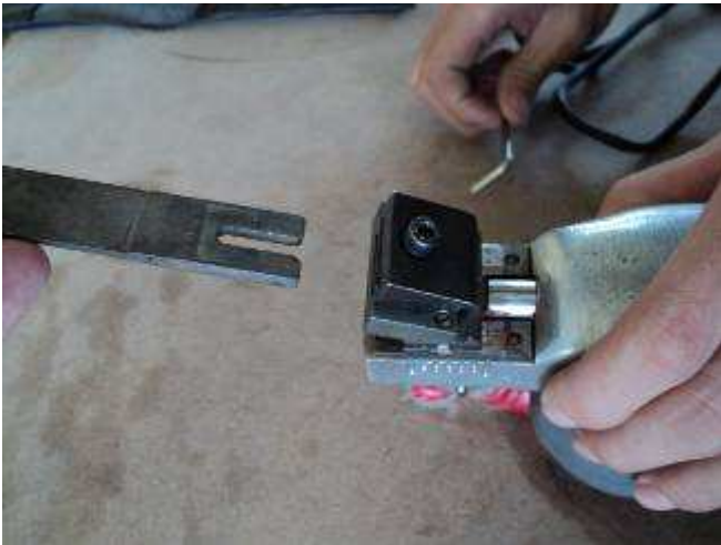
Foto 6: Jetzt haben wir noch ein Wi_8_f Bildungsdokument über das Schaben zu machen. Hier sieht man, wie man das Schabwerkzeug spannt.
