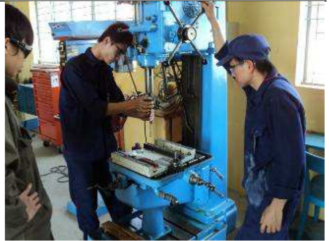
Foto 13: Der Schlitten der DM2S wird hier noch verstiftet. Das Erste mal dürfen die Lehrlinge verstiften.
