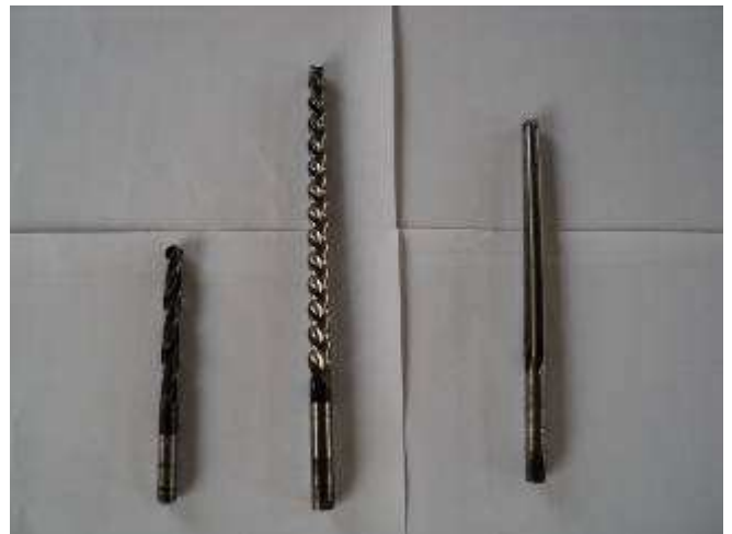
Foto21: Links ein 8 mm Bohrer, Mitte eine Maschinen Reibahle, rechts die Handreibahle 8mm
