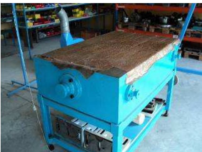
Foto 7: Unsere sehr schwere Touchierplatte hat eine Abmessung von 800 x 1200 mm
