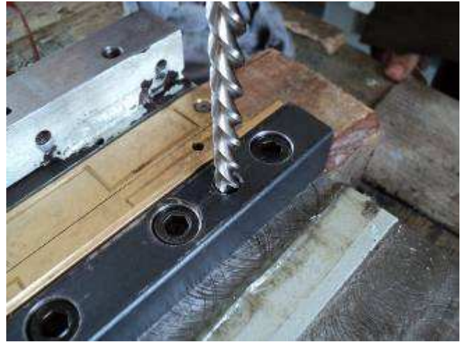
Foto 20: Noch einmal zum konischen Verfesten: hier eine Maschinen Reibahle im Einsatz
