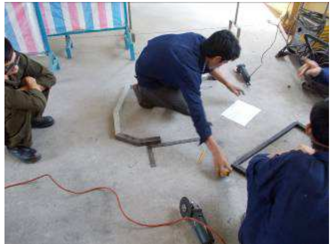
Photo19: Er zeichnet auf dem Boden das Gestell zum schweissen auf.
