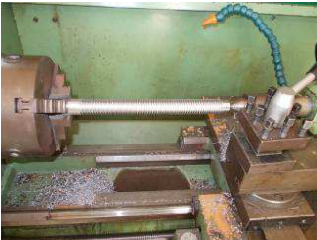
Photo 6: Wir sind natürlich schon sehr stolz darauf, dass unsere Lehrlinge heute Trapezspindeln und Trapezmutter selber machen können für unsere Schraubzwingen. Das war am ersten Tag als wir ankamen. Alle mussten drehen. Aber ohne Emulsion dürfen sie künftig nicht mehr drehen.
