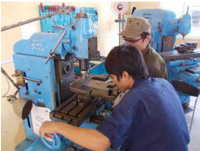
Photo 10: Hier beschriftet (fräst) der Lehrling Hieu (A09) die Schraubzwingen. Wir denken in Europa würde so etwas nicht gemacht, weil es zu teuer wäre. Als Schulung für die Jungen ist es eine gute Arbeit. Auch um das Durchhaltevermögen zu erkennen. Alle 12 Schraubzwingen beidseitig WIAP fräsen, ging knapp 3 Tage.
