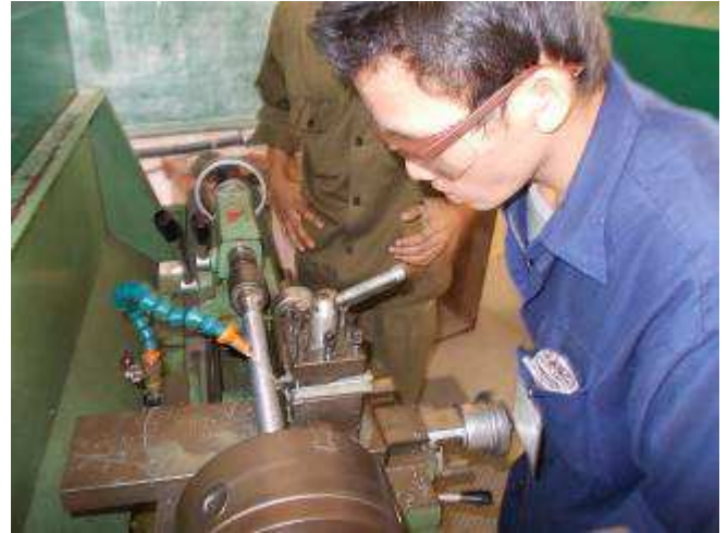
Photo 7: 220 mm lange Trapezspindeln, 26 x 4, selbst hergestellt.
