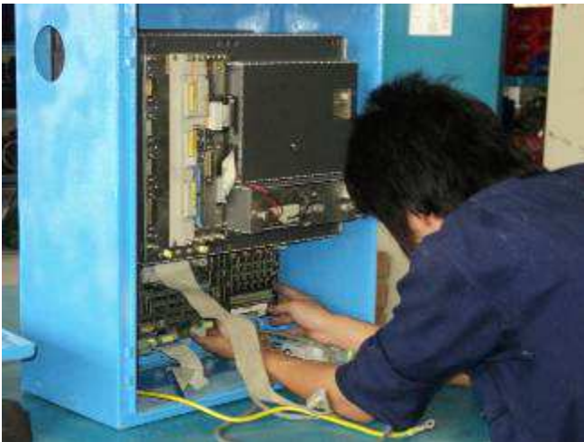
Photo 34: Noch im letzten Jahr haben wir gesagt, dass wir ein Gehäuse einer alten Sinumerik 810T neu malen. Zerlegt wurde sie, aber wie zusammen bauen wurde vergessen. Doch gut für die Jungen zum lernen. Es gleich neu aufzubauen, sauber, schön, damit Freude da ist, wenn die Türe geöffnet wird.
