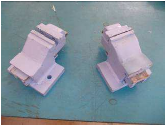
Photo 17: Vor Monaten sagten wir, dass wir eigene Schraubstöcke herstellen wollen für Schulen. Das heisst, zeichnen und herstellen in diversen Grössen. Diese 2 sind nun die Ersten. Es soll noch einiges verbessert werden. Diese haben zuviel Querspiel, ca. 2 mm, wir wollen aber nur 0,1 mm. Die nächsten werden so geändert, dass bearbeitet werden kann, da wo geführt wird.
