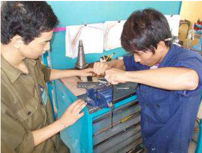
Photo 16: Eine grosse Anzahl Gewinde sind zu schneiden. M8x1 bei der Schmierung der Ausgang und M10x1 der Schmiereingang (Norm).
