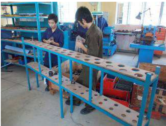
Photo 25: Unsere vielen Werkzeughalter die nur in Euro Paletten waren, werden jetzt in dieses Gestell weggeräumt. Das Holz muss noch gemalt werden, damit das Oel an den Haltern bleibt.
