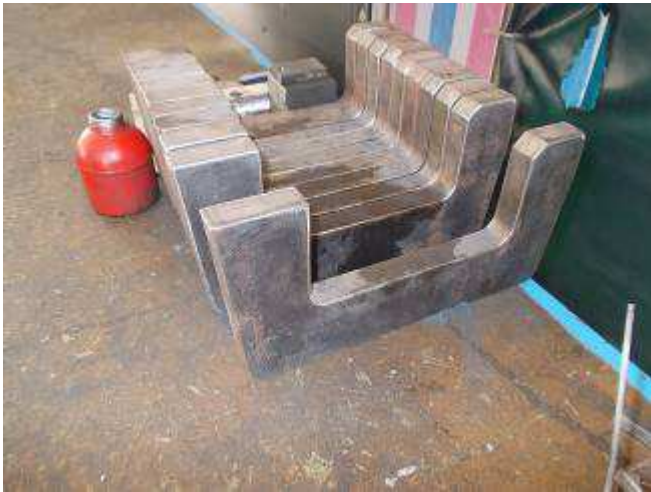
Photo 9: Diese Ausbrennteile für Schraubzwingen haben wir aus der Schweiz mitgenommen. Bestellt beim Henz; Stk. 26.- CHF
