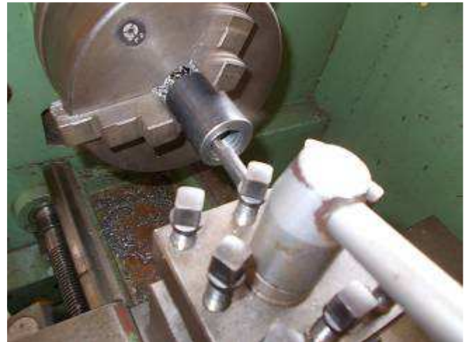
Photo 8: Die Trapezmutter wird gedreht. Gut machen die Jungen das, tip top. Und weil wir genügend machen, muss jeder drehen, das heisst, es es kann es jeder.
