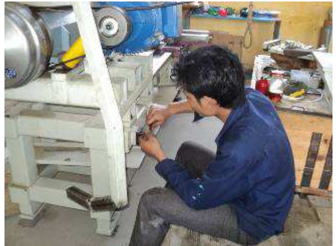
Photo 18: Lehrling Ba (A03) arbeitet zur Zeit an der Verschaltung der Schul Drehmaschine Wiap DM2S. Wir rechnen, dass wir noch ca. 8 Monate benötigen, bis diese eingeschaltet werden kann. Auch darum, weil wir ja nicht 100% hier sind. Wir müssen immer wieder stoppen, wenn wir gehen. Dieses Mal haben wir sofort als wir ankamen, an der Maschine weiter gemacht.
