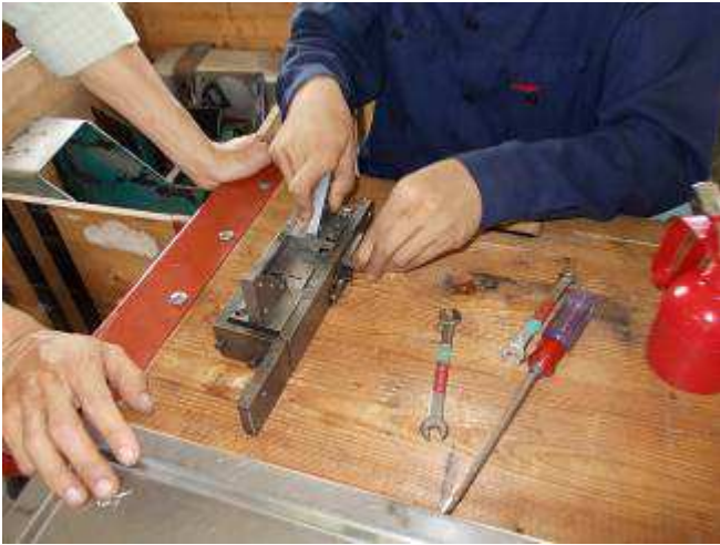
Фото 23: захвати з WIAP DM2V № 10023, був спорадично заклинено. Тепер він не працює.
