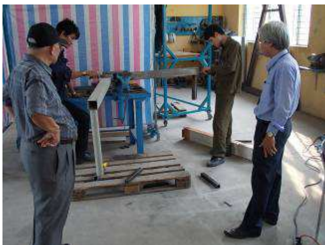
Фото 11: це шибениця для DM2S машини. Всі позиції з машини повинні бути в змозі легко керувати. Сума ми скорочуємо на 200 мм в порівнянні з Європою.
