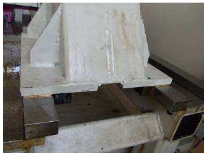
Foto 16: Der Reitstock, robust schwer. Mit Seitenführungen 8 x M16 befestigt. Jetzt dann noch einschaben.
