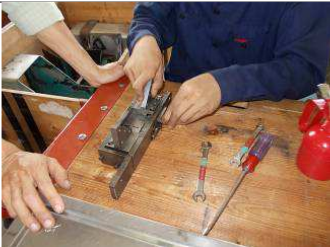
Foto 23: Der Greifer an der WIAP DM2V Nr. 10023, hat sporadisch zu geklemmt. Jetzt wird er zerlegt.
