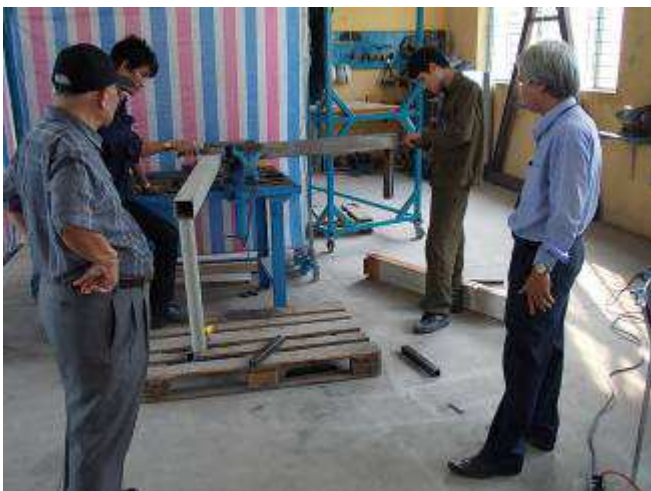
Foto 11: Das ist der Galgen für die DM2S Maschine. Alle Positionen der Maschine sollen leicht bedient werden können. Die Höhe reduzieren wir um 200 mm gegenüber Europa.
