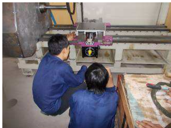
Foto 15: Der X Motor fertig angebaut.
