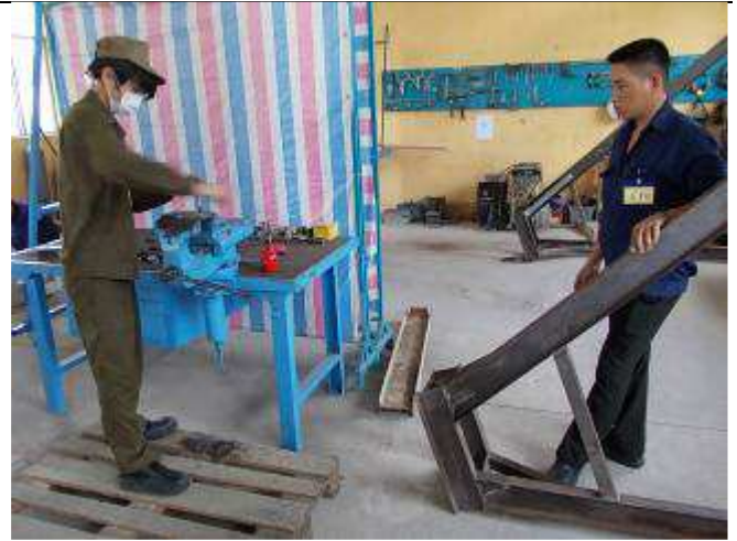
Foto 20: Gewindebohren M20 von Hand. Das gibt Kraft.
