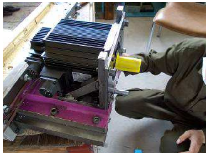
Foto 14: Das ist der X Motor, der jetzt am Kreuzschlitten angebaut ist.
