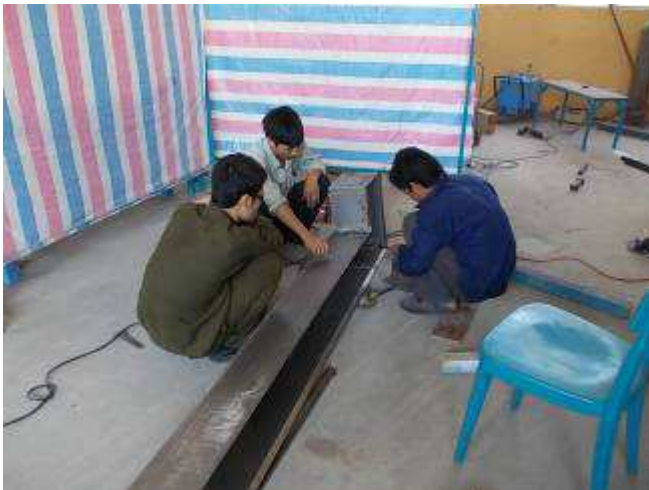
Foto 18: Das gibt der Kühlwasserbehälter zur DM2S Maschine. Alles ausgelegt für die 2 Meter-Blechmaschinen.
