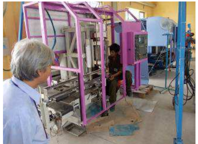
Foto 22: Die DM 2V Nr. 10022, benötigt mehr Zeit um sie herzurichten. Doch das ist gut. Mit so viel Lehrlingen muss man Arbeit haben, damit sie etwas lernen. Diese Maschine wurde fast komplett zerlegt, um sie herrichten zu können.
