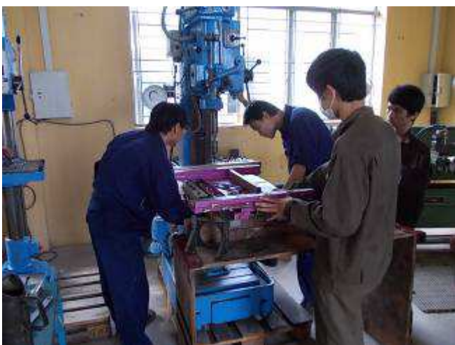
Foto 12: Da wird der Kreuzschlitten der DM2S gebohrt. Das nächste Mal haben wir einen Reguliertisch, damit alles ins Wasser gestellt werden kann.
