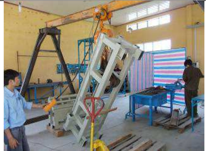
Foto 31: Jetzt heben wir das Maschinenbett der DM2 S hoch. Wir müssen eine Lösung zum Füllen haben. Das Füllstoff Konzept haben wir etwas geändert mit dem Losfüllstoff. Es gibt noch 2 Stück 800 mm Kranerhöhungen.
