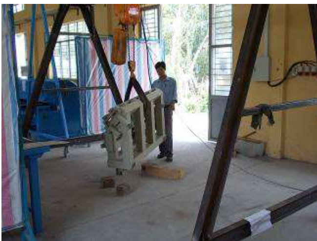
Foto 30: Gewichtstest. Bestanden, doch er schaukelt etwas beim seitlichen Fahren wenn er abbremst. Wir verstärken noch etwas.
