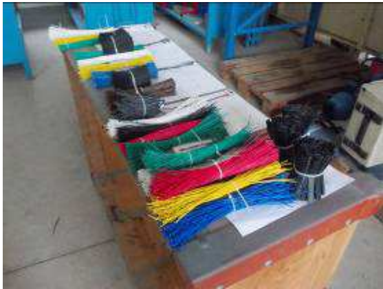
Photo 5: Vorbereitung der Drähte
