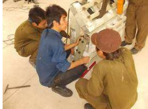
Photo 9: Die Befestigungsplatten werden angeschweisst.
