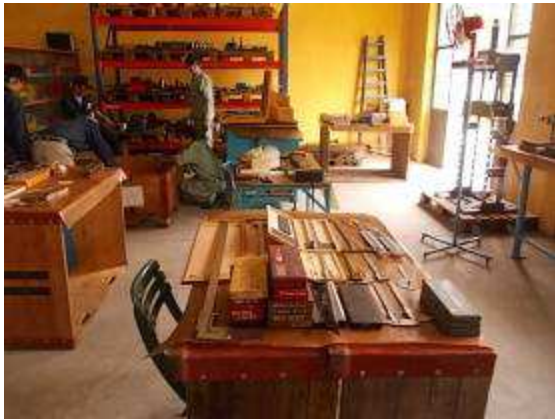
Photo 30: Jetzt wird es ein Messkurs geben nächste Woche. Alle Messmittel werden vorbereitet. Dann Unterlagen erstellt jedoch auch gleich alles geprüft und mit einem Oellappen eingestrichen. In Vietnam rostet es gerne.
