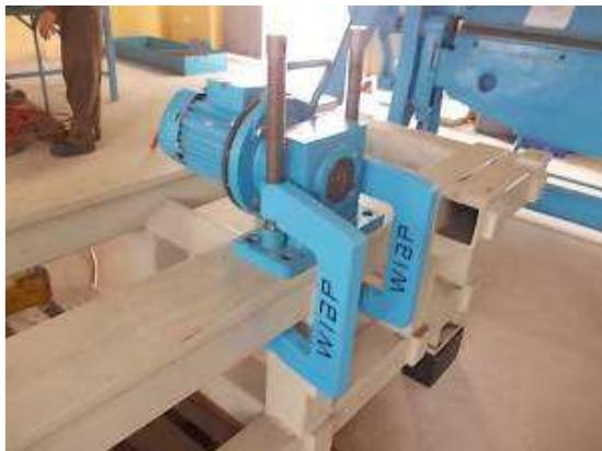
Photo 2: Unser alte Metall Entspannungsanlage WIAP LC 20
