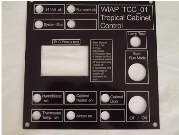
Photo 21a: Die Musterfrontplatte für das neue Tropen Cabinet Control TCC Gerät haben wir. Jetzt testen wir und dann bestellen wir 30 Platten. Dieses Gerät verhindert, dass immer die teure Elektronik zerstört wird in Tropengebieten wegen dem Kondenswasser. Es hat eine integrierte PLC.
