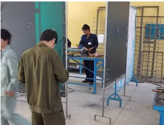
Photo 18: Unsere Schweisswände nehmen sie ab und zu einfach weg. Vorallem die Lehrer schweissen dann. Ohne Rücksicht auf Dritte und ob diese geblendet werden. Wir werden Minus Punkte verteilen an jene, welche dies künftig zulassen.
