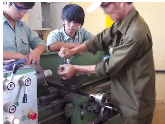
Photo 9: 30 Distanzringe in div. Längen herstellen mit Abstechen, ist hier der Job. Das machen jetzt schon alles B und C Lehrlinge.
