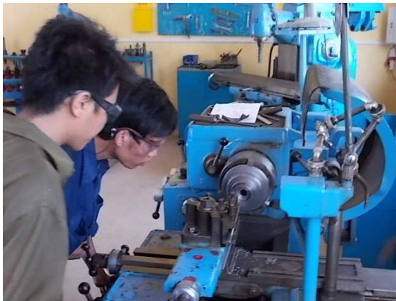
Photo 22: Dieser Lehrling dreht ein Flansch für die Metallentspannungsanlage Wiap LC 05. Wir haben 3 Stk. aufgelegt. Jede Anlage mit ca. 20 Positionen. Einige Lehrlinge haben damit etwas zu tun.
