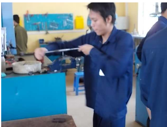
Photo 12: Wir benötigen Lochplatten mit vielen Gewinden; M6, M8, M10. Das gibt Muskeln, wenn alle von Hand gemacht werden müssen.
