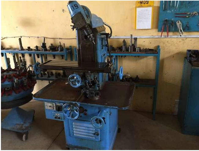
A Schaffner Milling suíça que entregue a partir do WiAP Suíça no ensino. Agora, a ferrugem está desaparecido. Algo como isso não deve acontecer! Sem emulsão para moinho e se refrescar com água pura. WS10_500 foto
