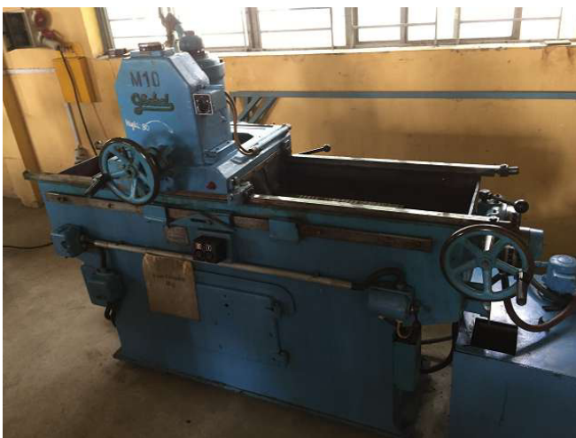
Cũng thứ hai, hơi nhỏ hơn, dễ quản lý hơn trụ máy xay này là lý tưởng cho mài trực cứng. Nó đã đồng ý với các hướng dẫn viên trưởng rằng điều này bây giờ được nối đất chắc chắn. Không gian 1b. ảnh WS10_580
