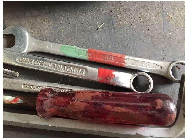
Ohne das 5S System gekannt zu haben, haben wir im Lehrbetrieb schon im Jahr 2010 alle Werkzeugplätze mit Farbe markiert. Wir lehrten die Jungen Ordnung, wie es alte Schweizer Lehrbetriebe aus früheren Jahren schon kannten. Raum 2. Foto WS10_130.
