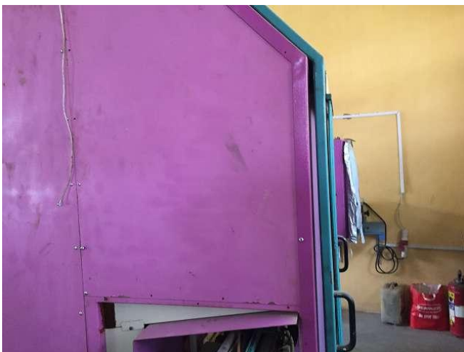
Maschine Wiap DM2V zum fertig machen. Die gespritzten Bleche wurden mit Farbe gespritzt, welche nicht mehr gut war. Sie müssen abgeschliffen und neu gespritzt werden. Raum 5. Foto WS10_620
