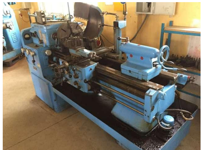
Jetzt sieht die Schweizer Drehmaschine aus dem Kanton Aargau Menziken, schon viel besser aus. Nach dem Tet Fest soll noch die Kühlmittelwanne unten sauber gereinigt und auch das Futter eingölt, werden. Raum 2. Foto WS10_470
