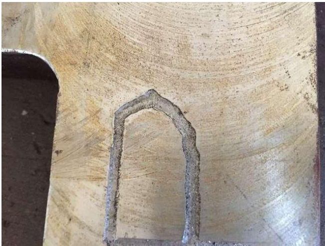
Die Sorgfalt beim Fräsen ist wichtig. Was misslungen ist, soll wieder zugeschweisst und neu gemacht werden. Das ist besser, als es so zu lassen. Es ist eine Schande, so eine Schraubzwingen wegzuwerfen. Doch sie muss weggeworfen werden, bevor sie Dritte sehen, wenn diese nicht repariert wird! Raum 2. Foto WS10_120.
