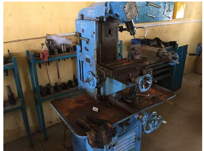
Bei dieser Schweizer Fräsmaschine Schaffner war alles rostig auf der Maschine. Ohne Kühlmittel, Emulsion, arbeiten ist nicht gut, dann rostet das sofort. Und zu lange den Rost einwirken lassen, frisst sich in den Stahl und hinterlässt Vertiefungen. Raum 2. Foto WS10_80
