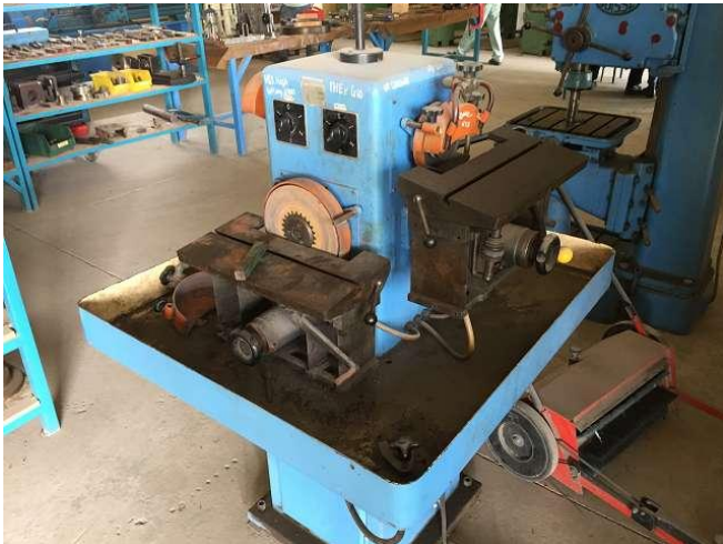
Eine exklusive Werkzeugschleifmaschine für 4 Schleifscheiben, wie auch Diamantscheiben war komplett verschmutzt und ungereinigt im Raum 2 Bearbeitung. Foto WS10_60
