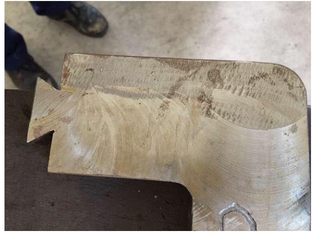
Auch diese Spuren von zu schnellem Vorschub, werden durch das Verzinken nicht weggehen. Das muss geschweisst werden oder die Schraubzwingen wegwerfen. Raum 2. Foto WS10_130
