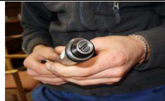
Photo 9: Man dreht den Einsatz durch das Werkzeug durch, vorne raus ins neue Gewinde.
