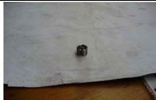
Photo 7 : Gewindeinsatz, ähnlich einer Feder. Man dreht den Einsatz in das grössere Gewinde und schlägt dann mit einem Durchschlag die unten sichtbare Querfeder raus. Da ist eine Kerbe drin.
