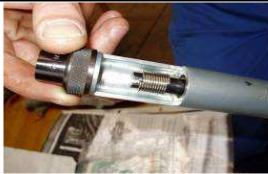
Photo 8: Hier setzt man den Helicoil Einsatz auf die Drehstange, sieht man den Helicoil Einsatz den man durch das vordere Gewinde dreht, dann im Werkstück ins neue Gewinde. Bitte beim Eindrehen kein Druck auf die Drehspindel geben. Danke. Man dreht den Einsatz durch die Gewindeführungspatrone. Der Mitnahmedraht muss immer nach vorne gucken, d.h. dann unten sein, um mit dem Schlagbolzen entfernt werden zu können
