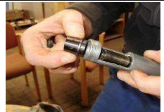
Photo 6 . Hier montiert man den Gewindeaufsatz vorher, aber die Drehstange noch rein drehen. Montage der Spannpatrone, sagt der Hersteller.
