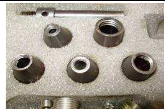
Photo 3 : Einsätze, welche vorne auf das Einschraubwerkzeug, Spindel mit Drehgriff, kommen
