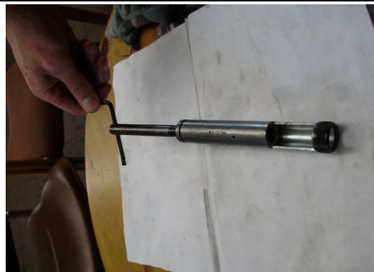
Photo 5 : Eindrehwerkzeug, Spindel mit Drehgriff von Helicoil
