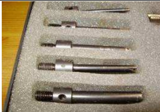
Photo 4: Einsatz, welcher den Helcoil Gewindeinsatz in das neue Gewinde reindreht. Hier M5 bis M12
