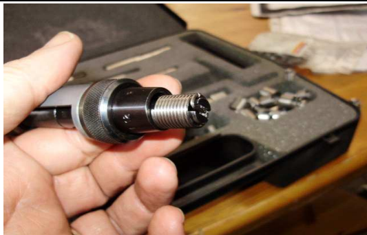
Photo 10: Nur zu Demozwecken haben wir den Helicoil Einsatz vorne raus gedreht. Normal geht der ins neue Gewinde, welches man vorher gebohrt und geschnitten hat mit den Werkzeugen, die im Helicoil Satz beiliegen
