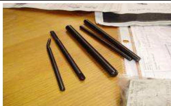
Photo 11: Durchschlag Werkzeug um den im Helicoil Einsatz den Querlappen raus zu schlagen. Bitte nicht mit dem Eindrehwerkzeug rausschlagen. Danke.
