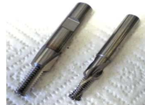
Gewindefräswerkzeuge für Innengewinde M10
