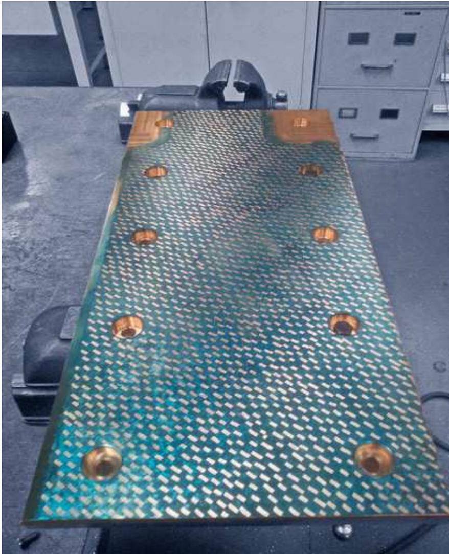
Schaben von Schlitten (Drehbänke, Fräsmaschinen, Pressen usw.)
