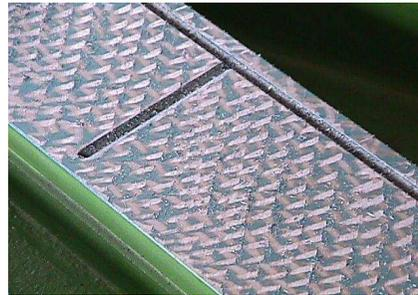
Schaben von Prisma-Flach-Führungsbahnen einer Flachsleifmaschine und messen mit elektronischem Nivelliergerät Niveltronic.
