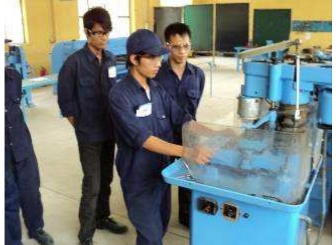
Photo 08: Die Schweizer Kleinschleifmaschine Hugi ist gut um Axiallagerspiele einzustellen für kleine Unterlagen resp. Zwischenlagen. Immerhin haben wir jetzt schon einige Lehrlinge, die damit umgehen können.
