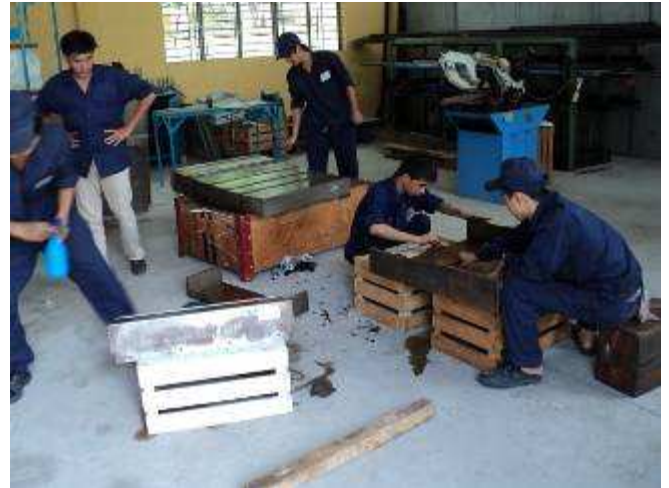
Photo 25: Hier hatten wir noch Abdeckungen eines SIP Lehrenbohrwerkes. Da war innert Kürze alles verrostet. Das ist ein grosses Problem, welches wir besser in den Griff bekommen müssen, der Rost.
