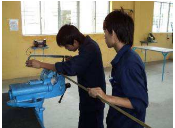
Photo 09: Richtig hinstehen, Beine etwas auseinander und Säge richtig in die Hand nehmen. Dann ein voller Zug, nicht nur wenige mm, damit das Sägeblatt nur in der Mitte abgenützt wird u.s.w. das musste und muss ich schon ab zu sagen, aber es kommt immer besser.
