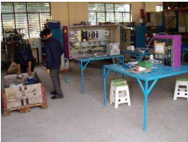
Photo 18: Wir bereiten den Elektroschrank vor für Strom und die CNC Sinumerik 802. Den Testlauf machen wir in der Elektrowerkstatt, weil man sich dann in der Montage nicht in den Weg kommt. Bis da einmal alles programmiert und getestet ist, das kann mit den Lehrlingen ein paar Tage gehen. Soll es auch, den nicht die Zeit, sondern was sie wissen danach, ist der Schlüssel.
