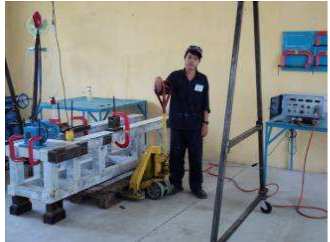
Photo 03: Dank unserer Metallentspannungsanlage können wir eigentlich ohne Einschränkungen, alles herstellen was wir wollen, ohne eine Glüherei suchen zu müssen. Rechts sieht man unsere alte, ca. 25 jährige Anlage Typ WIAP LC 20.
