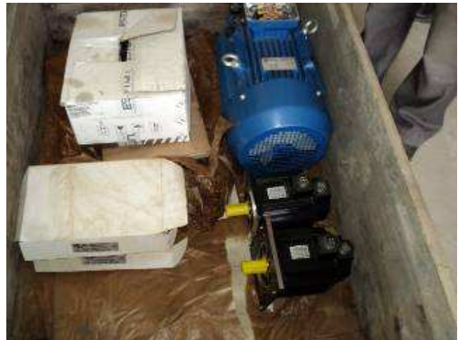
Photo 19: Hier haben wir den 5,5 KW Spindelmotor, sowie 2 Vorschubmotoren , die lassen wir gleich einmal im Palett drehen.
