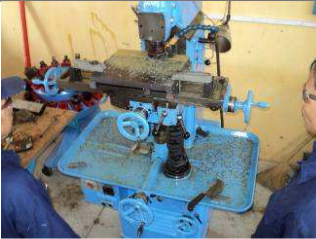
Photo 22: Unsere grosse Fräsmaschine hat leider einen Fehler. Die Spindel läuft nicht an und wir müssen die Kupplung des Vorschubes prüfen. Aber diese kleine Fräsmaschine geht so knapp für den X Schlitten der DM2 S. Wir wollen die Zeit nützen um so viel wie möglich an der neuen CNC Maschine machen zu können, darum haben wir die Reparatur der grossen Fräsmaschine verschoben.
