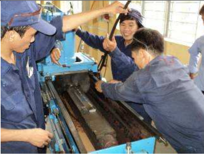
Photo 05: Unsere alte „Göckel“ Schleifmaschine macht die beiden Spindelstock-Unterleisten. Wir testen jetzt noch, dank dem dass sie 950 mm schleifen kann, ob wir ev. auch die Führungen damit selber herstellen können.
