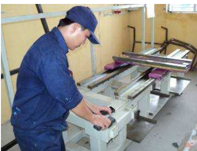
Photo 29: So jetzt wird auch die Spindelstock Konsolen Auflage abgezogen und gereinigt. Um alle Gewinde und sonstiges reinigen zu können, mussten wir für 2 Montageplätze Kompressoren kaufen. Einer kostete ca. 100 CHF. Daher haben wir entschieden, anstelle einer Zentralanlage, mit kleinen Kompressoren zu arbeiten, damit wir den Verlust der Leitungen nicht mit teurem Strom zahlen müssen.
