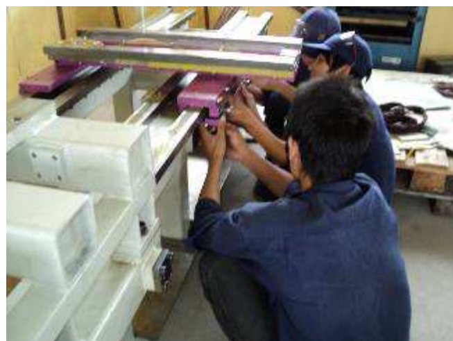
Photo 30: Jetzt werden endlich die Untergriffe montiert, die Lehrlinge führen diese Arbeit mit grösstem Respekt aus.
