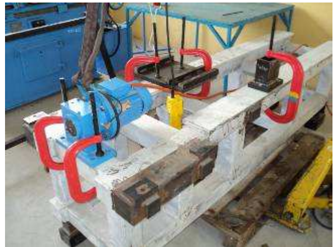
Photo 04: Hier entspannen wir den X Schlitten der DM2 S und für die neue, kleine Entspannungsanlage LC 05, das neue Gehäuse. Alles aufgespannt auf dem DM2 S Maschinen Bett, an welchem wir nach den Sommerferien weiter machen.
