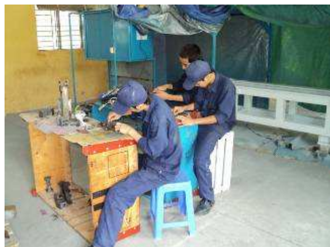
Photo 08: Mit großer Geduld können sie den Rost mit Schmirgelpapier an den Werkstücken abschleifen, die wir zum malen vorbereiten.
