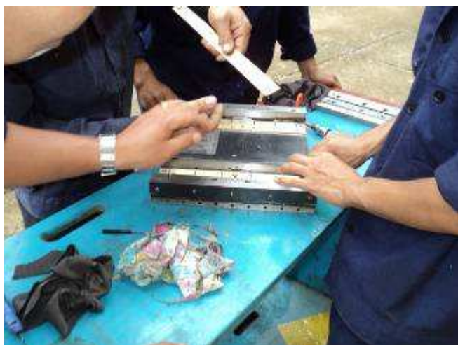
Photo 10: Seit wir 3 Kompressoren haben, ist die Pressluft für die Lehrlinge herrlich. Aber sie müssen draussen im Freien, alles gut abblasen und reinigen, damit keine Schmutzpartikel unter die Gleitbeläge kommen. Langsam erkennen sie, dass wir hier sehr aufmerksam sind und keine Toleranz kennen.
