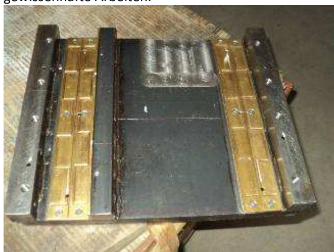
Photo 04: Dieser Schlitten hat viele Schmierbohrungen. Wir haben jetzt auch noch eine Aenderung entschieden, damit besser geschabt werden kann. Das geht ja gut, die Zeichnungen werden sofort geändert.
