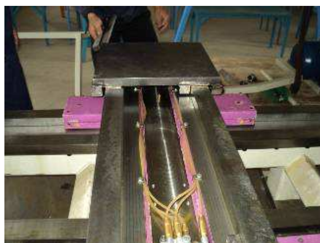
Photo 12: Hier wurde der X Schlitten aufgesetzt, jetzt wird geschabt.
