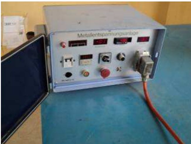
Photo 18: Dies ist eine alte Wiap LC 20 Metallentspannungsanlage, die wir von einem Schweizer Kunden zurückkauften, als er die Produktion änderte. Was täten wir ohne Vibrieren!
