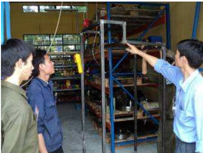
Photo 34: Hier haben wir ein neuer Absaug Ventilator Ständer gemacht, damit wir in der Malerei noch einen zweiten Absauger montieren können. Lehrer Robinson zeigt die Quaitätskontrolle. Kleine Löcher in den Schweissnähten, das geht zurück nachbessern.
