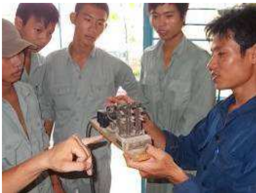
Photo 17: Ein uralter Siemens Schütz. Er kann sehr gut verwendet werden um es zu erklären, weil damals noch gar nichts isoliert war. Den Schützen haben wir einmal an einer Heyligenstaedt Drehmaschine Baujahr 1951, ersetzt.
