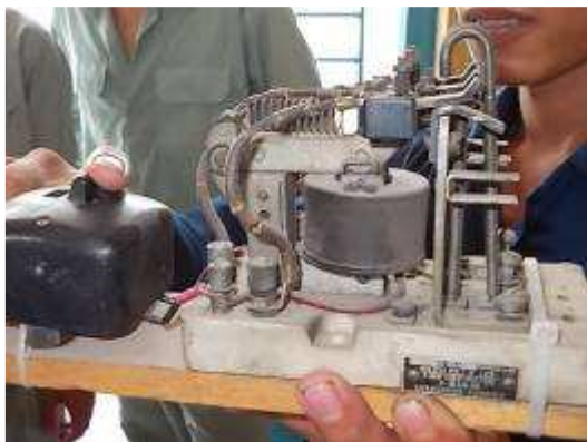
Photo 18: Schön, wie hier die Funktion von einem Schütz gut erkennbar ist.
