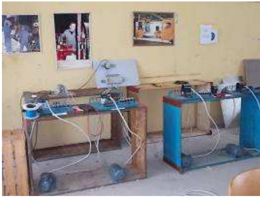
Photo 16: Schützen Testplatz mit 4 Motoren Linkslauf und Rechtslauf.
