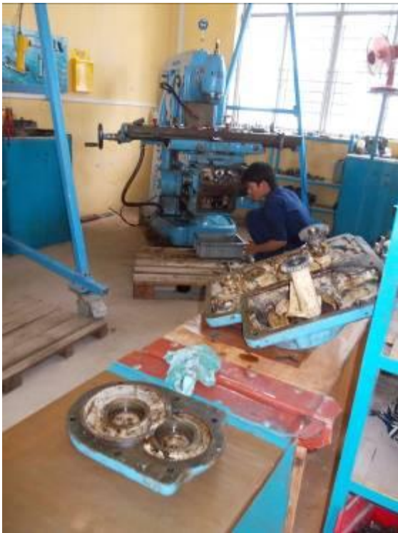
P18. Die Induma Fräsmaschine welche die Lehrlinge zerlegten um den Vorschub zu revidieren. Halle 2
