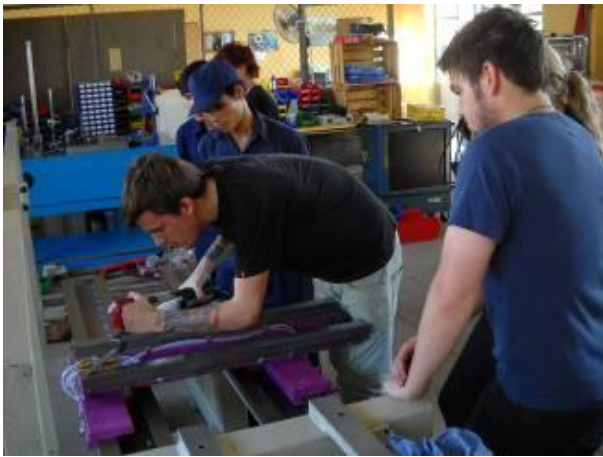
P 9: Jim Widmer zeigt den Lehrlingen wie geschabt wird mit der Schabmaschine.
