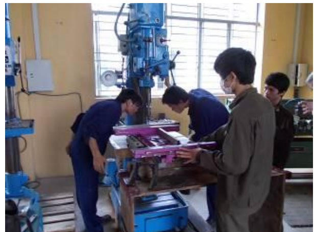
P7: Schweizer Radial Bohrmaschine beim bohren eines Schlittens der Flachbett CNC Drehmaschine des Längsschlitten der Wiap DM2S
