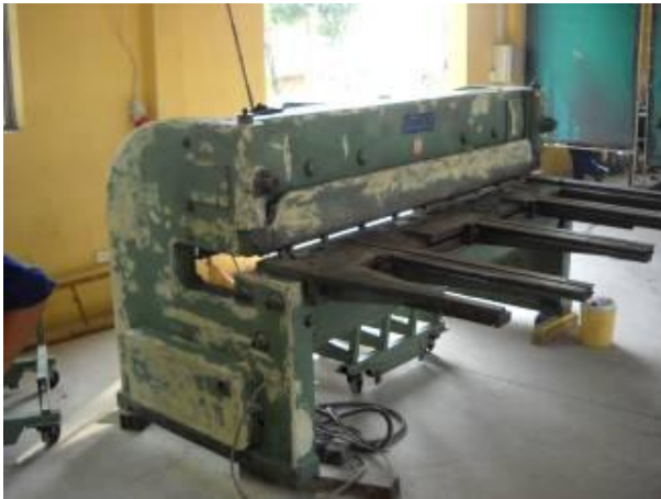
P13: Hängi Schweizer Schlagschere, die wir aus der Schweiz nach Vietnam brachten.
