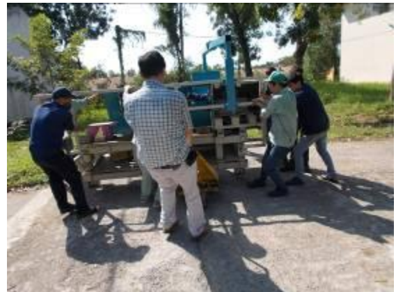
P11: Mit einem Palettwagen auf dem sehr schlechten Zementboden wird die Wuiap Flachbett Drehmaschine in die Montage Halle umgezogen.
