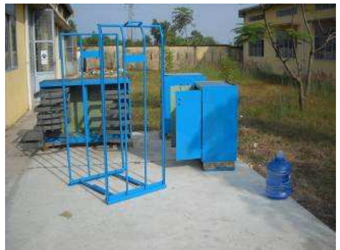
P22: Schränke, Gestelle, Stahllager alles wird neu gespritzt. Aber bei uns nicht über den Schmutz. Auch hier, es darf nicht begonnen werden mit malen, bevor man nicht kontrolliert hat, ob alles sauber geputzt ist.
