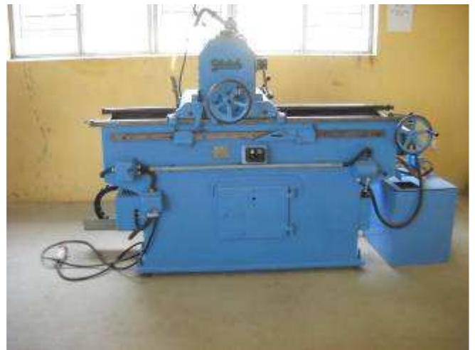
P16: Deutsche Flachsleifmaschine, eine Göckel 1000mm länge 100 mm Breite scheiflbar.
