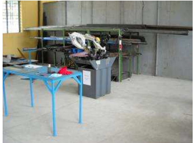
P26: Raum 3a, Material Lager mit einer Bandsäge für 150mm Vierkant und 200 mm Flachstahl und 6 Meter langes Material.
