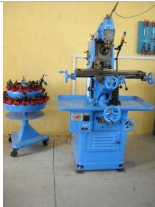
P9: Schaffner Fräsmaschine aus der Schweiz, ISO 40, Tisch 200x750mm.
