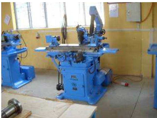
P19: Rund Schleifer "Studer", länge Spitzenhöhe 110. Spitzenweite 500mm
