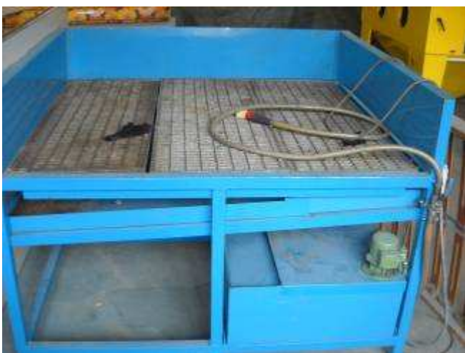
P31: Das ist unser Wasch Platz Wiap , 1200x 1200mm mit einer Wasser Pumpe. Unsere Konstruktion und Herstellung.
