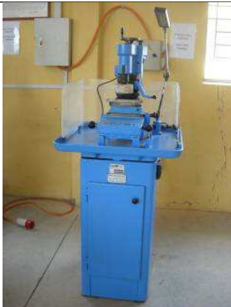
P17: Flachschleifmasch. Hugi Schweiz. Max 100mm.
