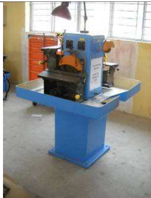
P13: Hier eine Werkzeug Schleifmaschine Solid DS3. Wir haben viele Drehwerkzeug, Stein und Diamant Schleifer für das Werkzeug.
